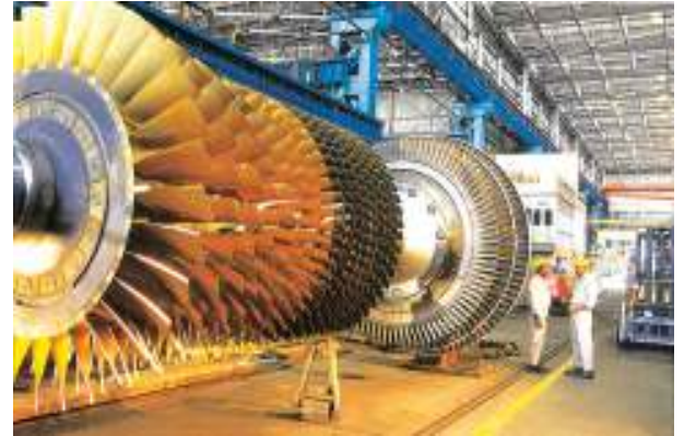
চিত্র 6.10 : BHEL (হায়দ্রাবাদ)-এ গ্যাস টারবাইন রোটারের (Gas Turbine Rotor) সমাবেশ স্থান
