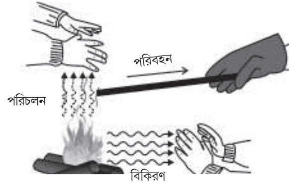
চিত্র 11.13 পরিবহন, পরিচলন ও বিকিরণের দ্বারা উত্তাপীকরণ।
