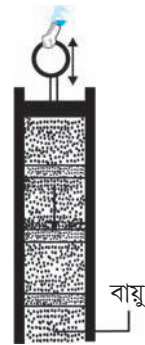
চিত্র 15.4 : পিস্টনের উপর-নীচ গতির সাহায্যে বায়ুপূর্ণ নলে অনুদৈর্ঘ্য তরঙ্গের (শব্দ তরঙ্গের) উৎপাদন। তরঙ্গ বিস্তারের অভিমুখের (বা বিস্তার রেখার) সমান্তরালে এক নির্দিষ্ট আয়তনের (volume element) বায়ু কম্পিত হয়।
